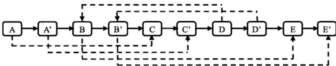
图 4.10 复制复杂链表的第二步
