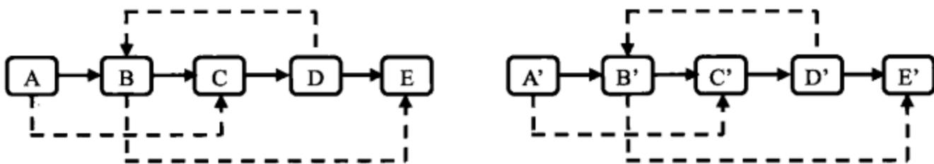
图 4.11 复制复杂链表的第三步
