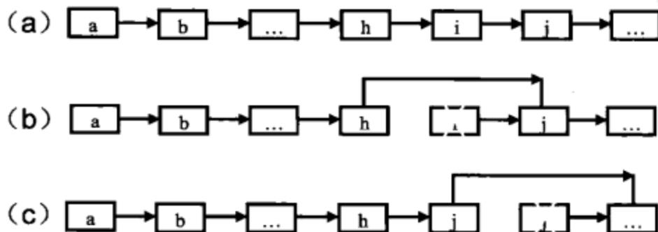
图 3.3 在链表中删除一个结点的两种方法
