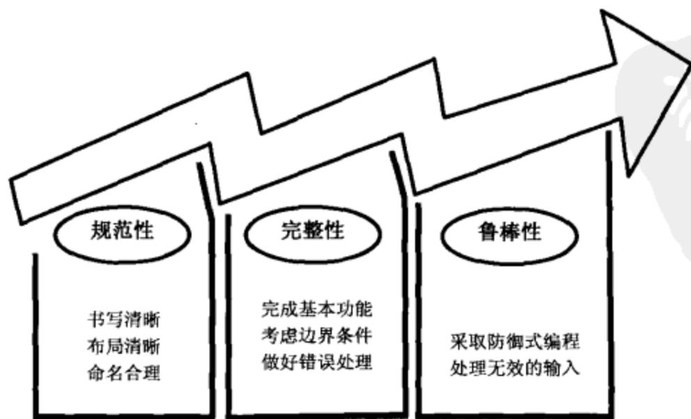
图 3.12 从规范性、完整性和鲁棒性 3 个方面提高代码的质量
