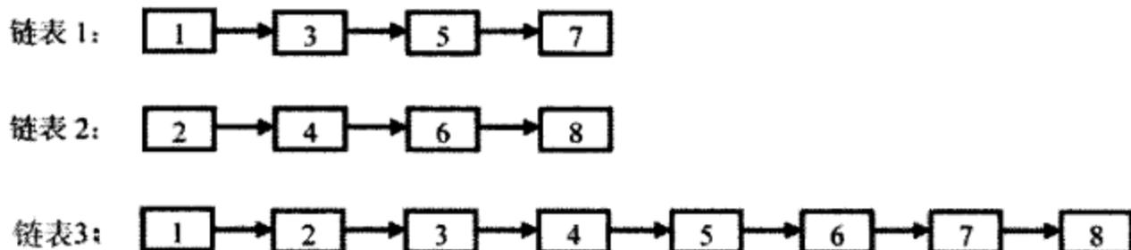
图 3.7 合并两个排序链表的过程
