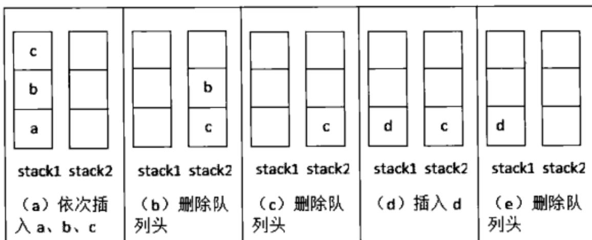
图 2.8 用两个栈模拟一个队列的操作
