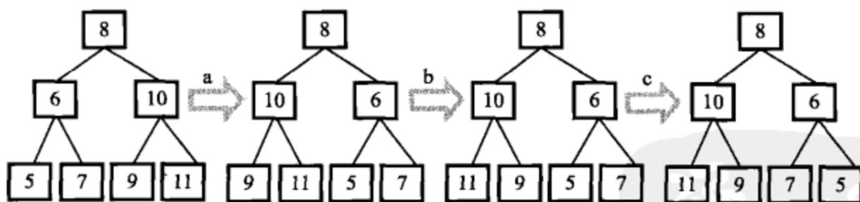
图 4.2 求二叉树镜像的过程
