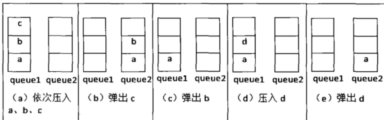
图 2.9 用两个队列模拟一个栈的操作
